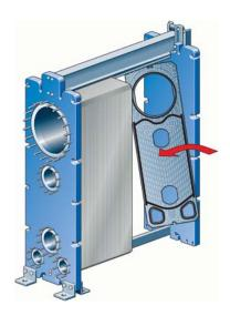
压紧板片装置。压紧工作分两步进行,请 参见下图。请务必确保固定板和压紧板始 终平行。
