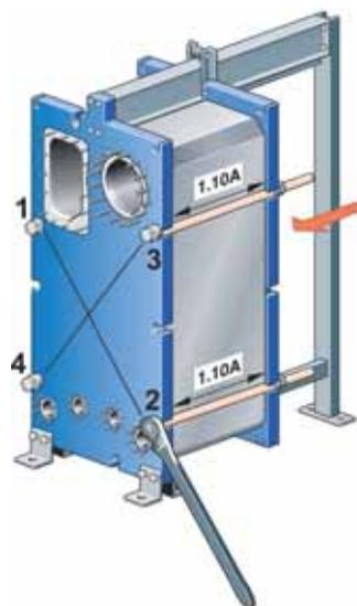
Этап 2: После этого болты затягиваются попеременно-диагонально, как показано на следующем рисунке. Затягивая используемые болты, измеряйте расстояние А.
